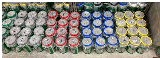
写真-1 養生状況
