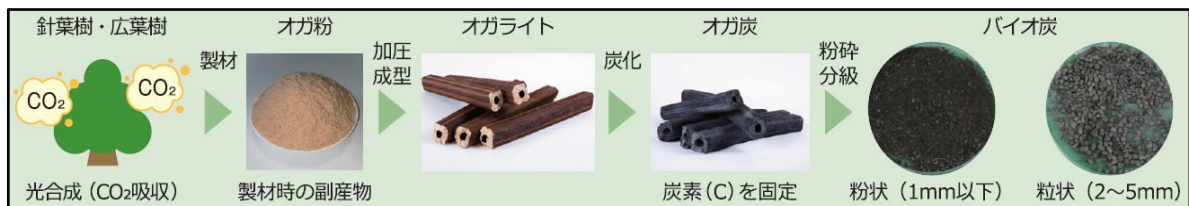
図-2 検討で用いたバイオ炭の製造プロセス 1)
