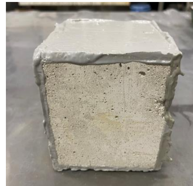
写真-1 促進中性化供試体
