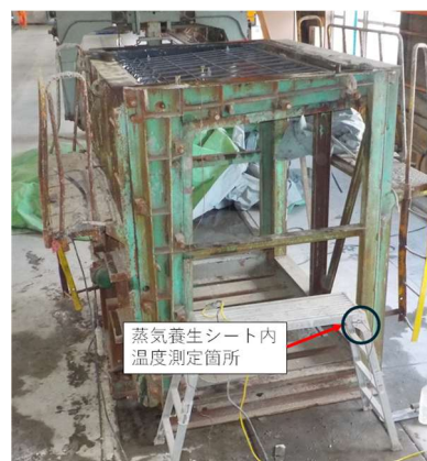
写真-2 L型擁壁製造
