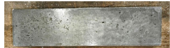
図-15 春期に製造した BFS コンクリートの外観（1,000 サイクル）
