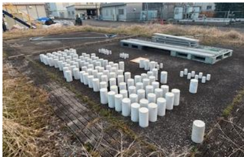
図-3 コンクリートの暴露状況
