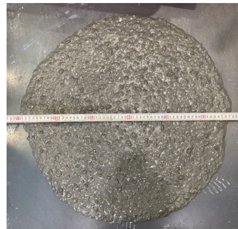
写真-1 スランブフロー試験状況例 (No. 3)
