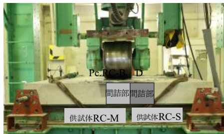
図-5 輪荷重走行疲労試験の状況
