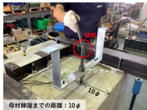
a) アンカー筋の破断（母材強度22.9N/mm 2 ）
