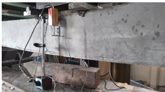
VF-0：試験体2（アラミドロッド+スターラップ有）
