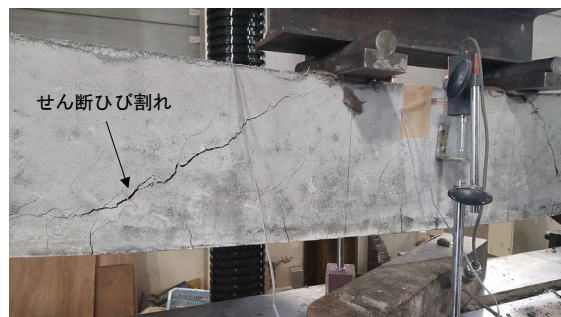
VF-1：試験体3（アラミドロッド）
