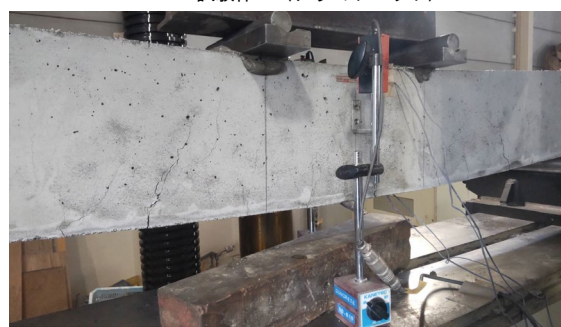
VF-4：試験体3（アラミドロッド）
