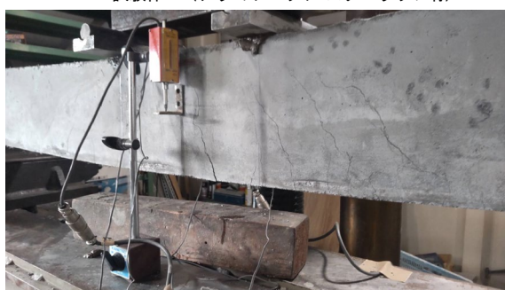
VF-2：試験体3（アラミドロッド）
