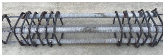
図-3 軸方向鉄筋を UHP-SHCC で被覆した状態
