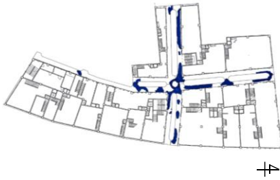
図-6 降雨時の滞水箇所とコンクリートの剥落状況
