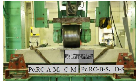
図－6 輪荷重走行疲労試験の状況
