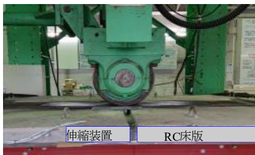
写真-1 輪荷重走行疲労実験装置
