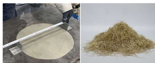
写真-1 フロー試験(左)と混入した鋼繊維(右)
