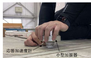
写真－3 強制振動試験の計測状況
