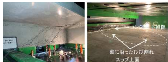
(a) 最大荷重後( P=806\text{kN} ) (b) 最大荷重後( P=806\text{kN} )
