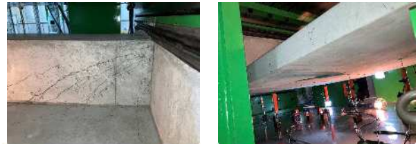
(a)最大荷重後 ( P=944\text{kN} ) (b)荷重低下後 ( P=736\text{kN} )
