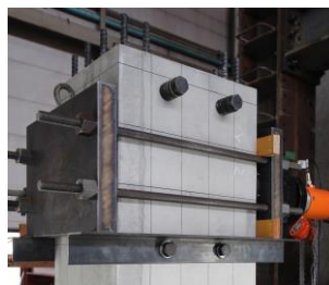
写真-2 加力部付近の治具
