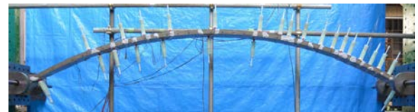
図-3 内圧充填接合補強工法の様子
