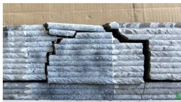
写真－7 No. 1 の試験体（終局後）
