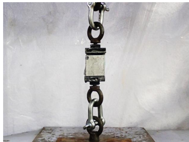
図－3 直接引張試験の状況
