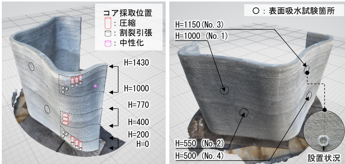
図-3 コア採取位置（左）と表面吸水試験の試験箇所（右）
