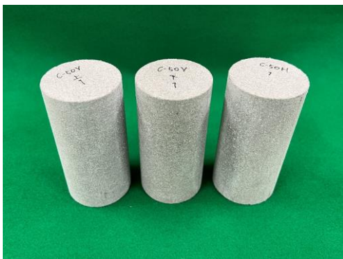
写真-4 採取した供試体 (左から : C-50V 上部, C-50V 下部, C-50H)
