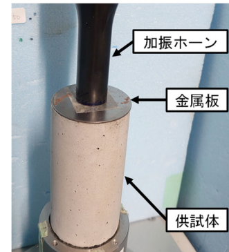
図-3 加振ホーン先端と供試体
