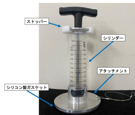
写真-1 シリンダー法の試験装置
