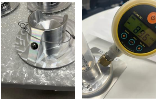
写真-2 アタッチメントの加工および 圧力計の設置の様子
