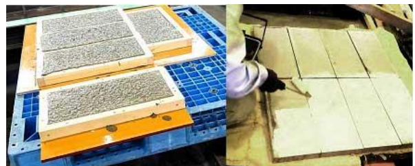
図-5 製作中の試験体と塗料の塗布状況
