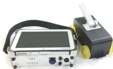
図-7 近赤外分光装置の写真 コントローラ(左)とプローブヘッド(右)
