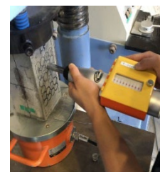
写真-1 反発度試験
