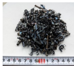
写真-4 ブロック内の材料（左からクエン酸、鉄鋼スラグ、鉄くず）
