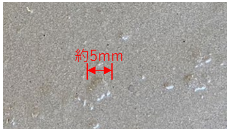
写真－1 練り混ぜ直後のペースト表面 (乾燥灰, F70)
