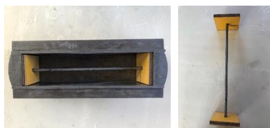
写真-1 鋼製型枠及び長孔のための丸鋼設置状況
