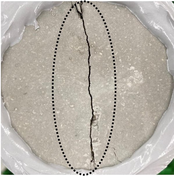
図-5 導入したひび割れ
