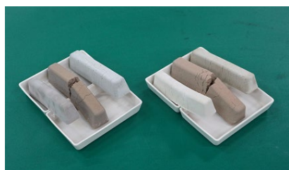
800°C 1000°C 図-8 形状安定性試験の結果 (左から AAM, GP (BS10), OPC)
