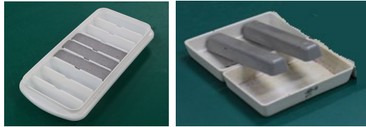
図-2 型枠と供試体の配置状況
