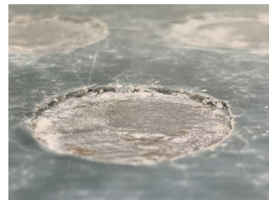
図-13 ペーストの膨張の様子 (N-SAP1.0%の場合)
