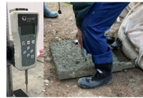
写真－7 ペネトレーション試験
