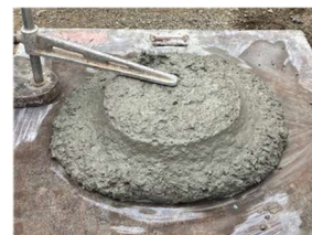
写真－8 スランプ性状
