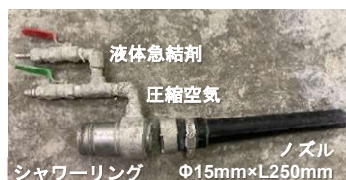
写真-3 ノズル・急結剤添加部
