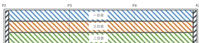
図-9 幅員方向3分割の施工イメージ
