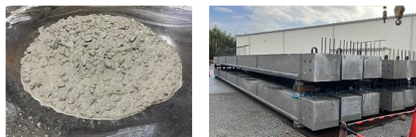
写真-4 スランプフローと製造した実部材
