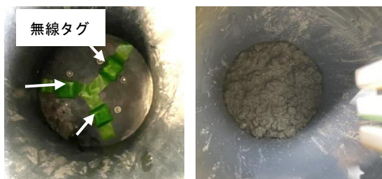
写真-6 無線タグの設置方法 写真-7 試料投入後
