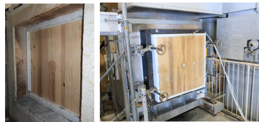
写真-2 壁炉への試験体の設置状況
