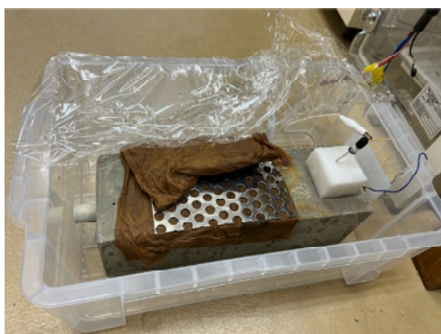
写真-1 0.2 mV/min 測定時の様子 (測定後にラップをはずした状態で撮影)
