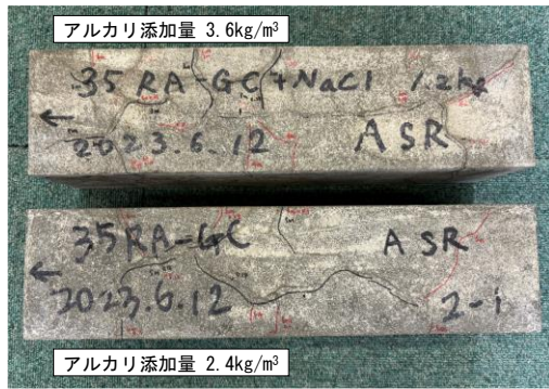
写真-1 コンクリートバー供試体の外観の一例 (C-2.4 および C-3.6 の供試体上面)
