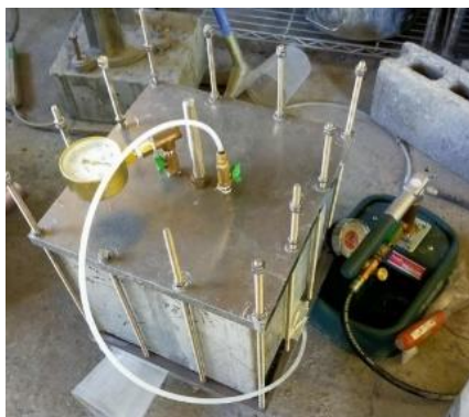
図-13 水圧をかけて水密性を調べる装置の外観
