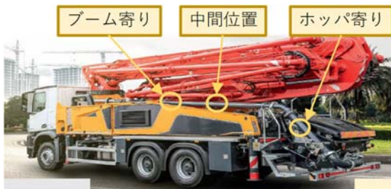
写真-1 コンクリートポンプに対する端末の設置位置 (画像はポンプメーカーのカタログ 4) から引用)
