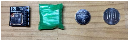
図-2 防水加工した無線タグ
