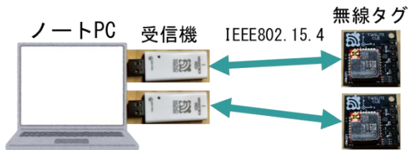
図-1 加速度計測システムの概要
