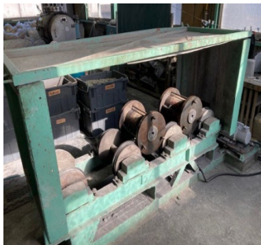
写真-1 遠心成形型枠と遠心成形機
