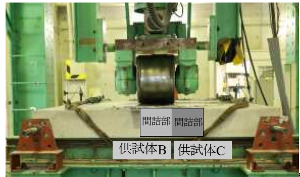
写真-2 輪荷重走行疲労試験の状況
