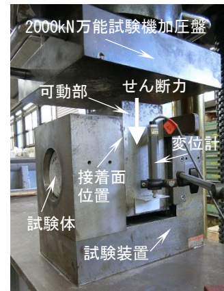
写真-2 1面せん断試験方法
