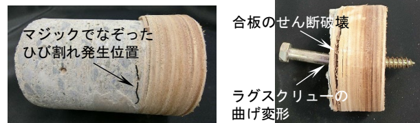
b) PAN-1 のコンクリート内のせん断破壊
