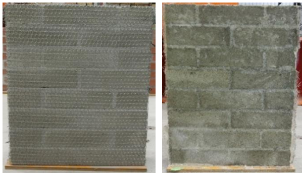
(a) ワイヤーメッシュ補強 (b) GFRPシート補強 図-2 応急補強を施した試験体（横目地破壊型）
