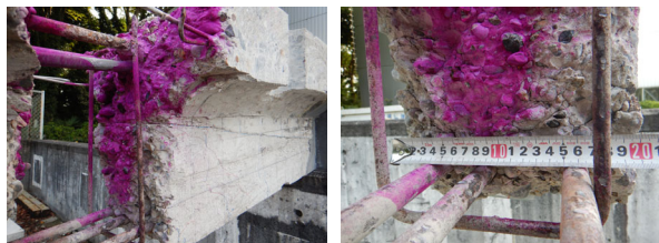
(a) 溶液塗布 (b) 計測 写真-3 コンクリートの中性化深さ測定
