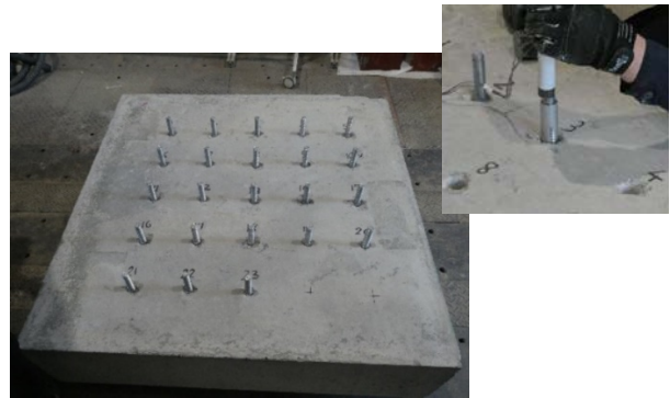
(a) 下向き施工
