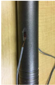
写真-1 打込み棒に貼付されたひずみゲージ
