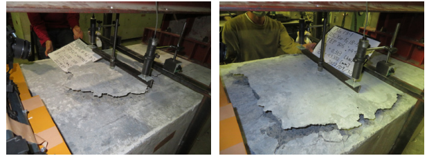
コーン状破壊 コーン状破壊 No.11-2 D25_Yio-Fc18-4d-B-2 No.13-1 D25_Yio-Fc18-5d-B-1
