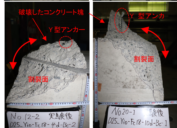
コーナ一部割裂破壊 No.12-2 D25_Yio-Fc18-4d-Bc-2 No.20-1 D25_Yio-Fc18-10d-Bc-1 写真-1 最終破壊状況の一例
