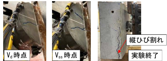
写真-1 せん断試験体損傷状態
