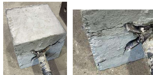
図-4 破壊後の試験体の様子 (cross-4)
